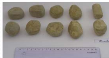
Τεμάχια μάργας προετοιμασμένα για την εκτέλεση δοκιμής.
